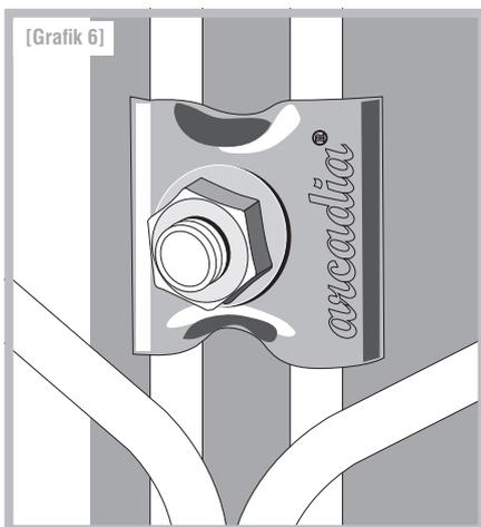
Befestigen Sie die U-Schiene oberhalb jedes Kreuzpunktes der Säule (alle 20 cm) an den dafür vorgesehenen Stanzungen mit jeweils einer Flachrundschraube, Sperrzahnmutter und Universalklemme.
